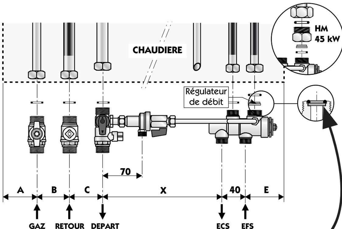
**Monter impérativement le régulateur de débit dans le logement prévu dans le RTA**
