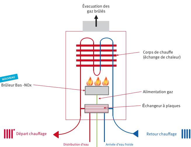
L'eau chaude pour la douche ou le bain est produite à travers l'échangeur à plaques, ce qui garantit une étanchéité entre l'eau des radiateurs et l'eau chaude sanitaire.
